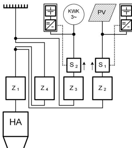
Variante mit mehreren Erzeugungsanlagen und Speichersystemen in den jeweiligen Erzeugungspfaden.
