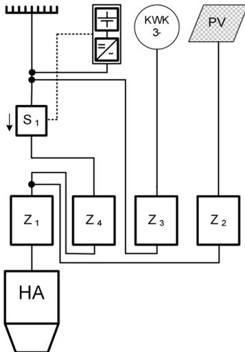
Bei dieser Variante ist der Speicher nicht fest mit der EZA gekoppelt. Der Sensor S1 misst die Energieflussrichtung zum öffentlichen Netz.
